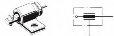
Fig. 5. Deze doorvoercapacitor is verkrijgbaar tot een capaciteitswaarde van ca. 2,2 μF. De condensator kan direct aan massa worden gelegd met bijvoorbeeld een zelftapper.
